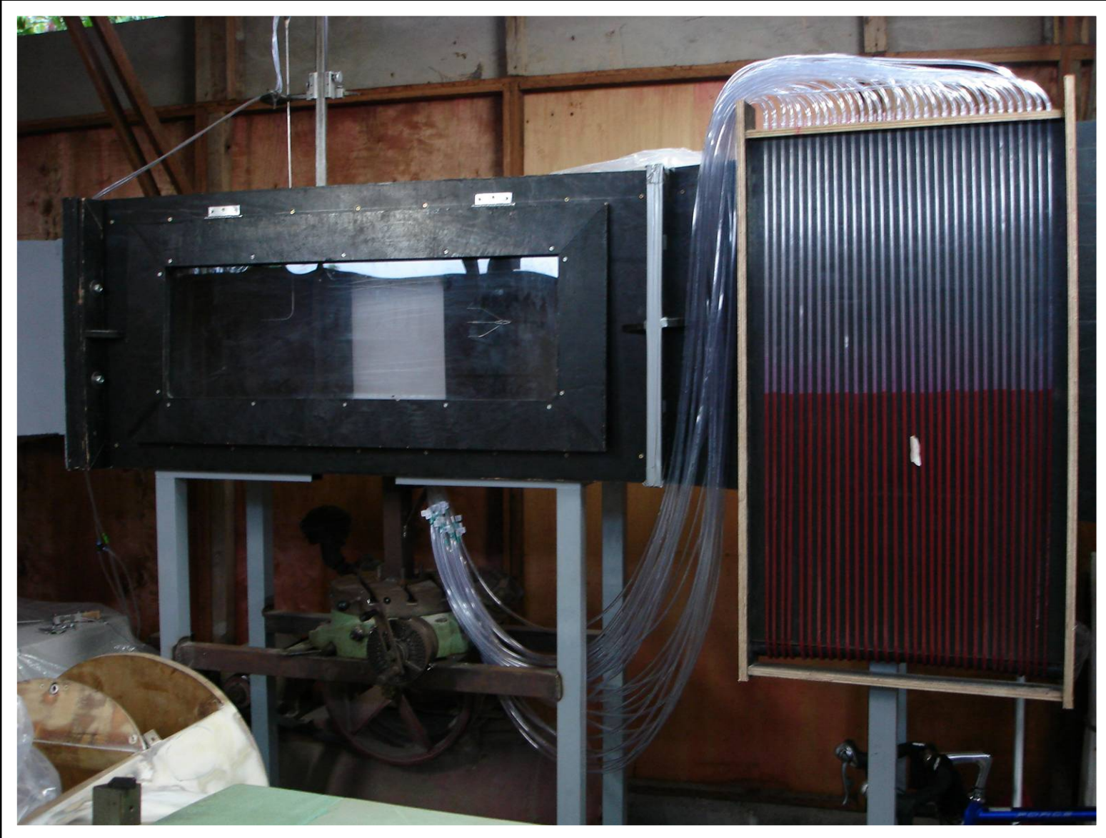
Primeiros teste com aerofólios no Túnel de Vento Didático do CEA-UFMG
