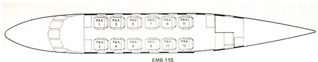
Figura 5 – Distribuição dos assentos da aeronave EMB-110 Bandeirante
