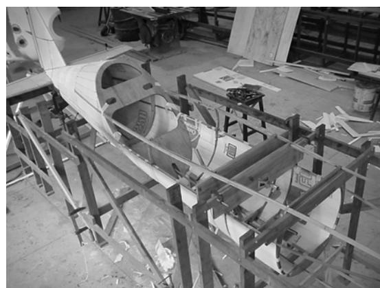
Figura 3 . Instalação das espumas na fuselagem
