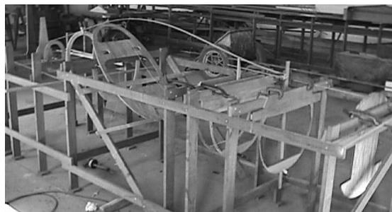
Figura 2 . Estrutura em madeira da fuselagem
