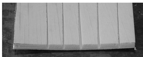
**Figura 5 . Detalhes dos entalhes na espuma para melhorar o dobramento**
