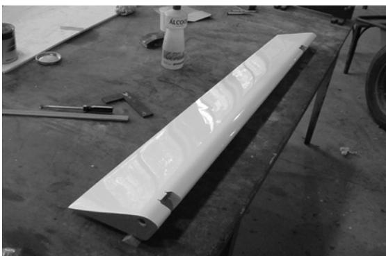
**Figura 7 . Ailerão da aeronave CEA-308 com acabamento final**
