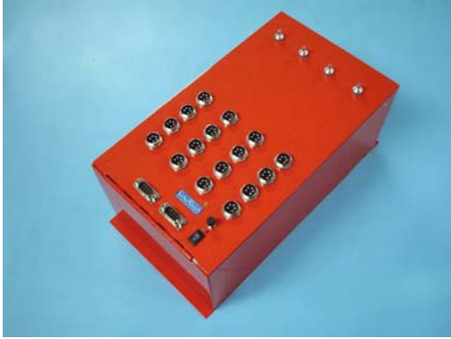
Figura 2 – Caixa de aquisição de dados, CEA-FDAS
