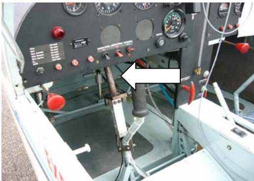
Figura 6 – Célula de carga instalada no manche
